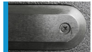
Robuste Gleitkufen aus Melaminharzplatten seitlich und am Boden.
